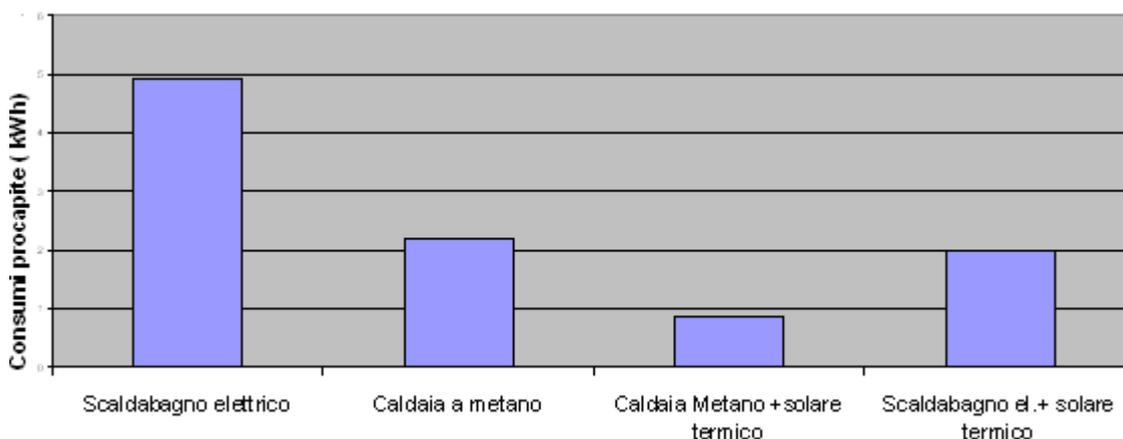
Si osserva allora che, nel passaggio dalla soluzione con scaldabagno elettrico a quella con caldaia a gas integrata da collettori solari, il consumo energetico procapite passa da 4,93 a 0,87 kWh. E' il caso più interessante, dunque, che porta ad **una riduzione dell'82% del consumo energetico, a parità di servizio reso.**
